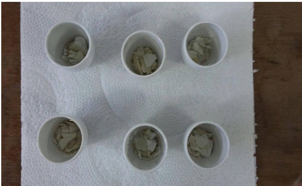
Slika 8. Izgled barijevog sulfata nakon sušenja i žarenja
