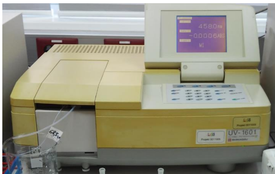
Slika 3.12. Korišteni spektrofotometar UV-1601 Shimadzu Co., UV-vidljivi spektrofotometar.
