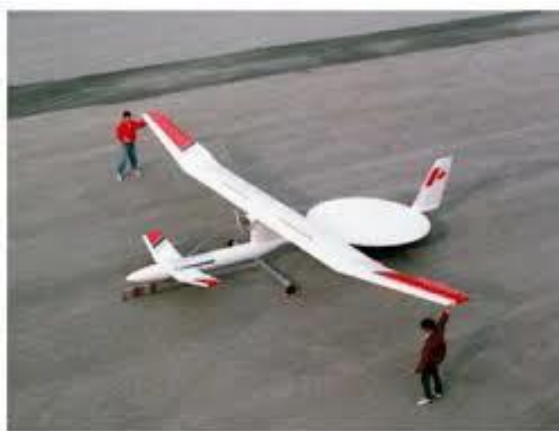
Slika 2.5. SHARP-ov avion na napajanje mikrovalovima. [25]
