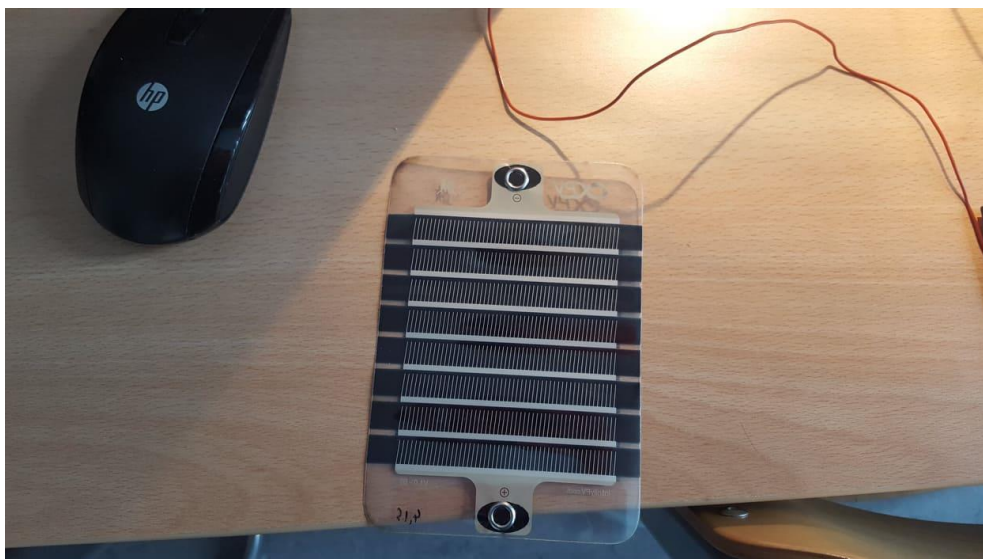
Slika 2.6. Modul izrađen od organske polimerne ćelije
