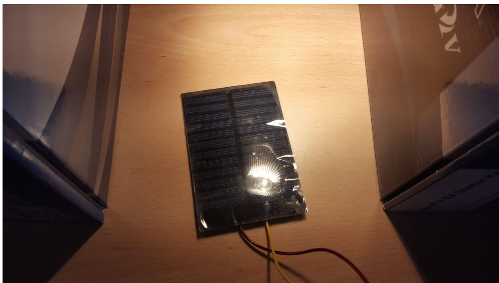
Slika 2.4. Modul izrađen od monokristaličnog silicija
