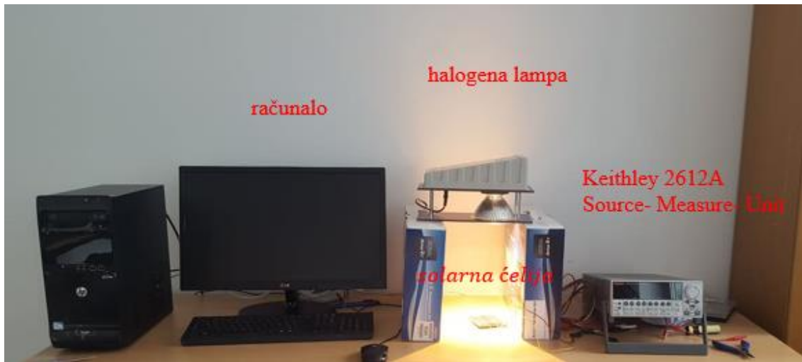
Slika 2.3. Fotografija mjerenja I-U karakteristike
