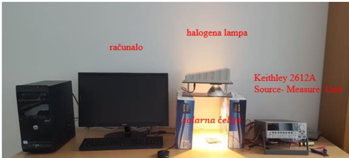
Slika 2.3. Fotografija mjerenja I-U karakteristike
