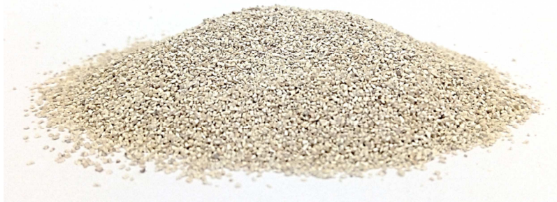
Slika 2.7. Prirodni zeolit klinoptilolit (nalazište Zlatokop, Vranjska Banja, Srbija) veličine čestica 0,09 - 0,56 mm.
