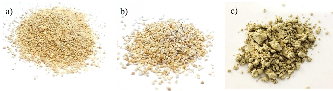
Slika 2.3. a) PZ veličine čestica 0,09 - 0,56 mm, b) NaZ3 veličine čestica 0,6 - 0,8 mm i c) ZSM-5 veličine čestica 0,0045 mm.
