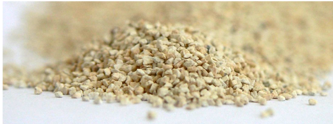
Slika 2.1. Uzorak zeolita klinoptilolita veličine čestica 0,6 - 0,8 mm.
