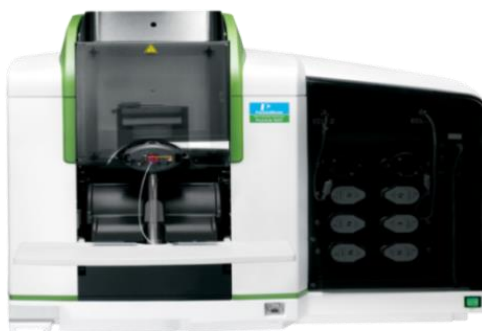
Slika 12. Atomski apsorpcijski spektrometar 34
