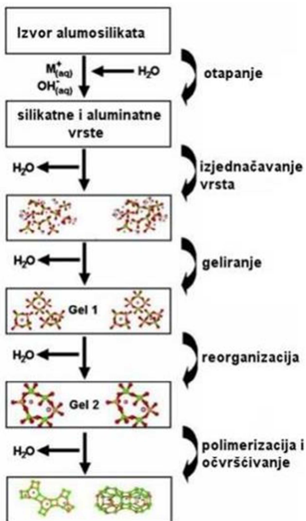
Slika 1.6. Duxsonov model geopolimerizacije. 2
