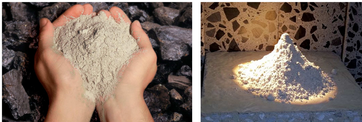
Slika 1.3. Sirovine za pripremu geopolimera a) leteći pepeo; b) metakaolin. 8,9
