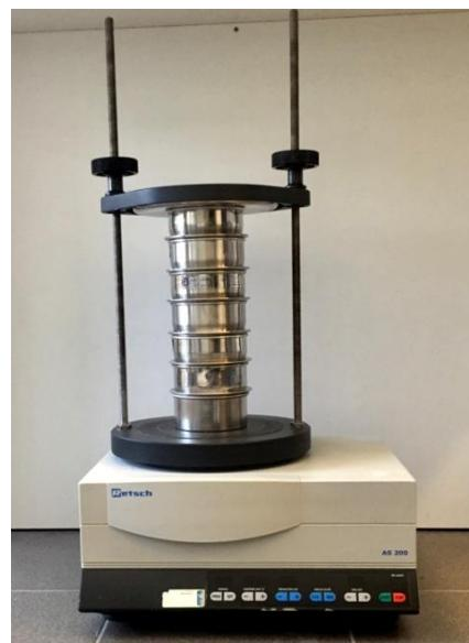
**Slika 17.** Aparatura za određivanje granulometrijske analize prosijavanjem.
