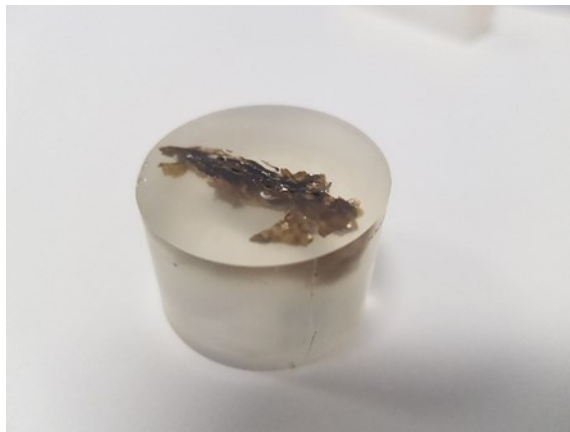
Slika 10. Uzorak alge Padina pavonica u epoksi smoli.
