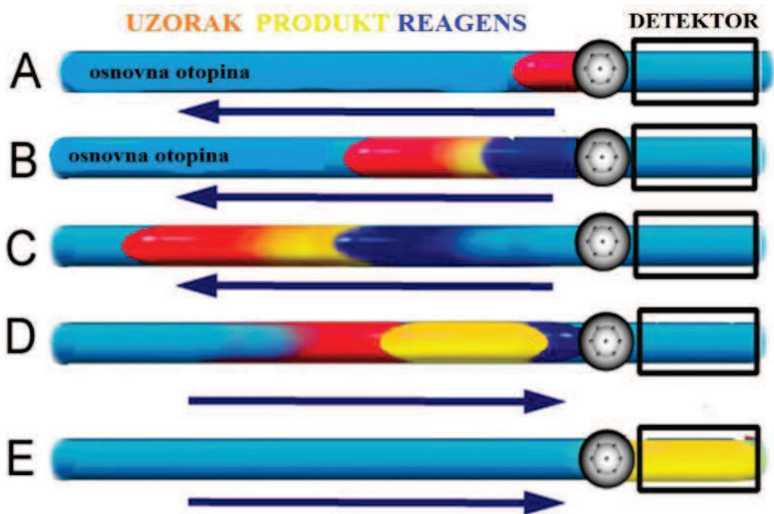
Slika 1-4 Formiranje zone koja se prenosi do detektora (zona uzorka miješa se s osnovnom otopinom i zonom reagensa pri čemu nastaje produkt reakcije). 13
