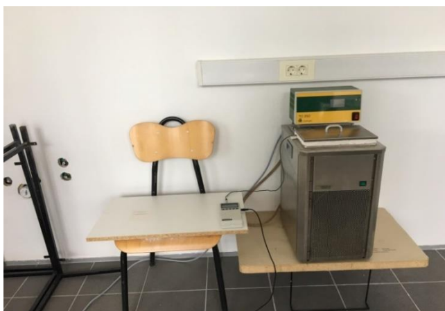
Slika 11. Aparatura za praćenje topline hidratacije
