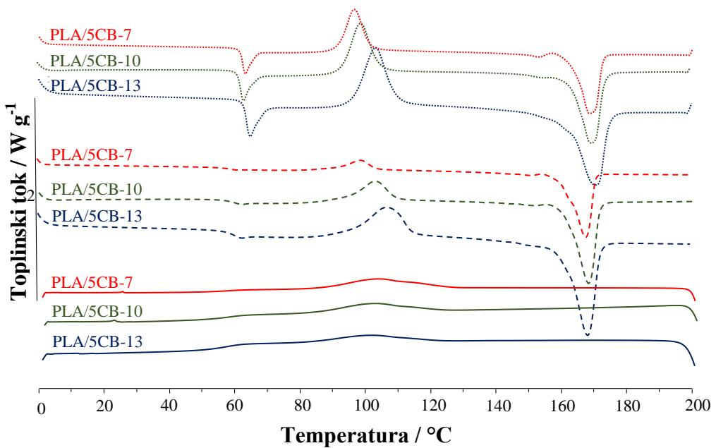
**Slika 19.** DSC krivulje prvog zagrijavanja, hlađenja i drugog zagrijavanja PLA/5CB kompozita snimljene pri brzinama zagrijavanja/hlađenja 7, 10 i  $13 \text{ }^{\circ}\text{C min}^{-1}$
