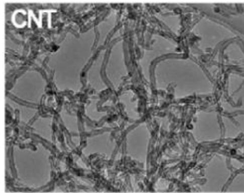
Slika 8. Mikroskopski prikaz CNT-a<sup>13</sup>
