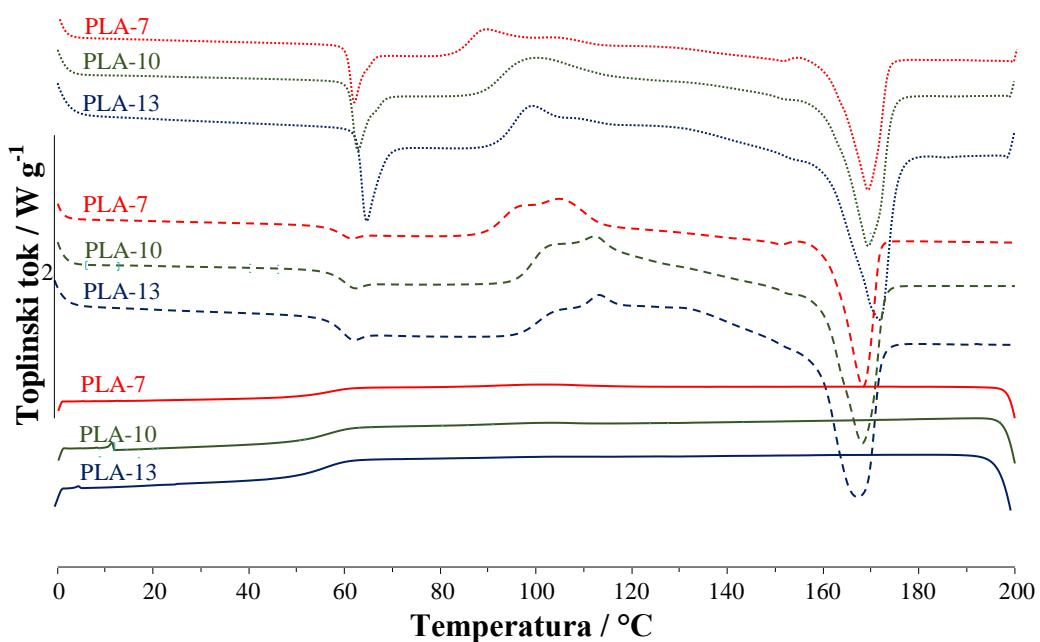
**Slika 16.** DSC krivulje prvog zagrijavanja, hlađenja i drugog zagrijavanja PLA snimljene pri brzinama zagrijavanja/hlađenja  $7, 10$  i  $13 \text{ }^{\circ}\text{C min}^{-1}$
