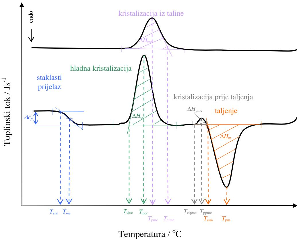
**Slika 15.** Određivanje značajki krivulje diferencijalne pretražne kalorimetrije
