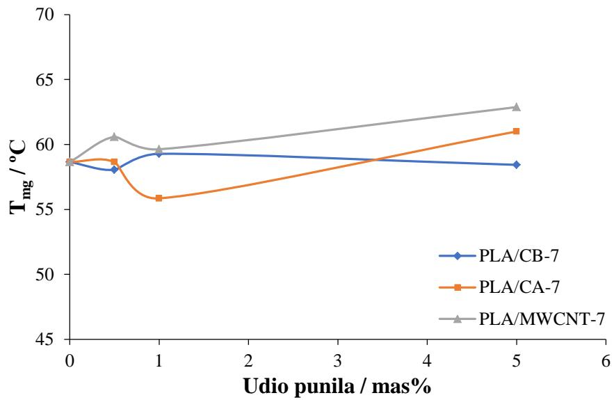
**Slika 32.** Ovisnost  $T_{mg}$  o udjelu CB, CA i MWCNT u PLA kompozitima nakon drugog zagrijavanja brzinom  $7 \text{ }^{\circ}\text{C min}^{-1}$
