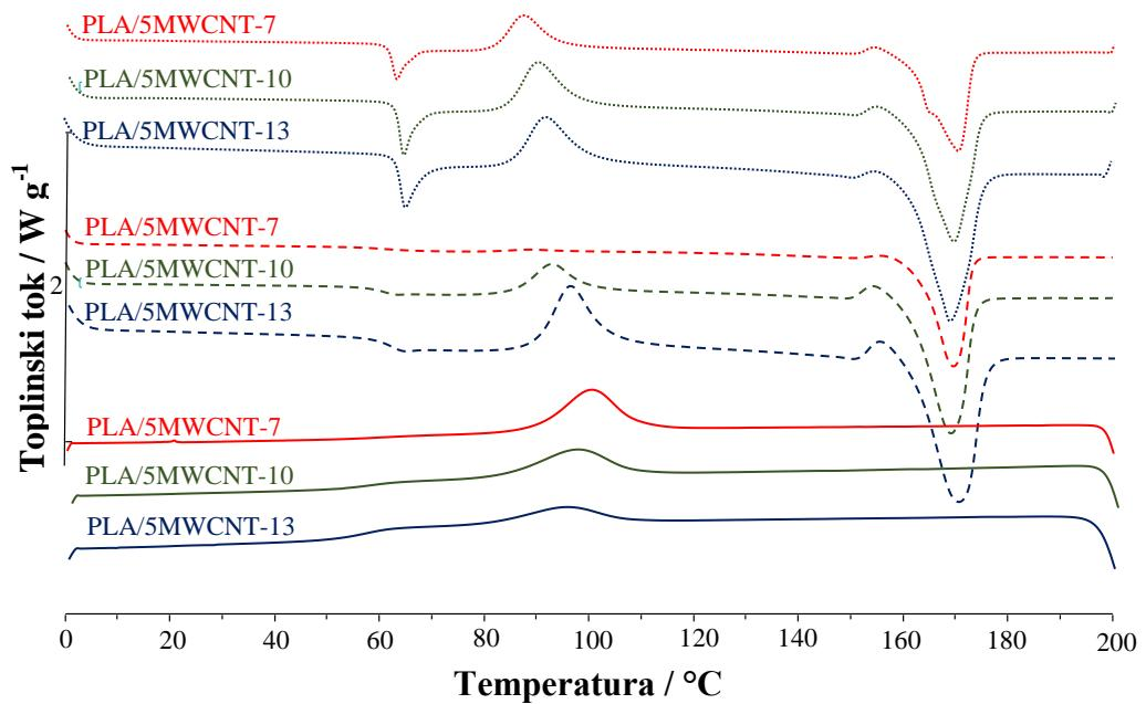
**Slika 25.** DSC krivulje prvog zagrijavanja, hlađenja i drugog zagrijavanja PLA/5MWCNT kompozita snimljene pri brzinama zagrijavanja/hlađenja 7, 10 i  $13\text{ }^{\circ}\text{C min}^{-1}$
