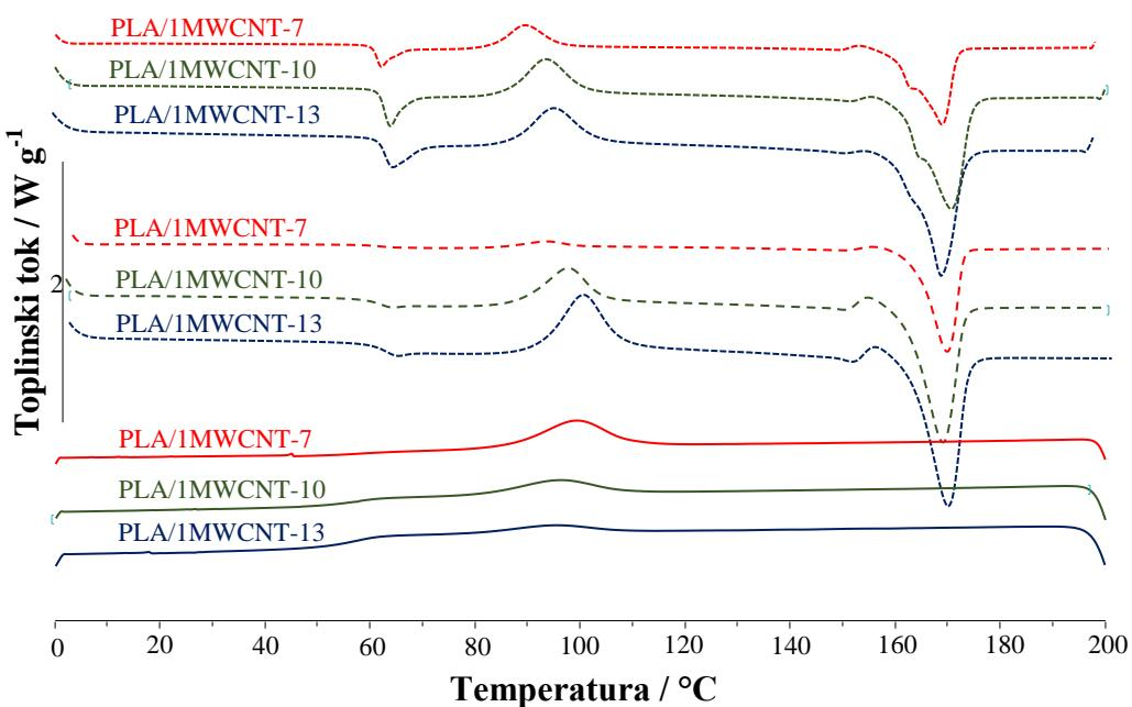
**Slika 24.** DSC krivulje prvog zagrijavanja, hlađenja i drugog zagrijavanja PLA/1MWCNT kompozita snimljene pri brzinama zagrijavanja/hlađenja 7, 10 i  $13 \text{ }^{\circ}\text{C min}^{-1}$
