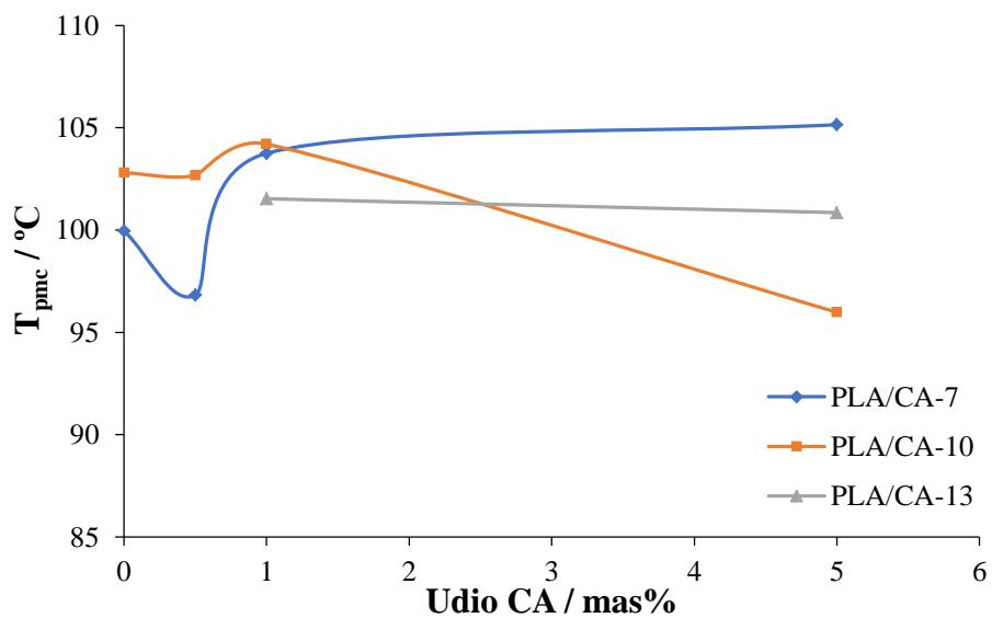
**Slika 27.** Ovisnost  $T_{\text{pmc}}$  o udjelu CA u PLA kompozitu nakon hlađenja brzinom 7, 10 i  $13 \text{ }^{\circ}\text{C min}^{-1}$
