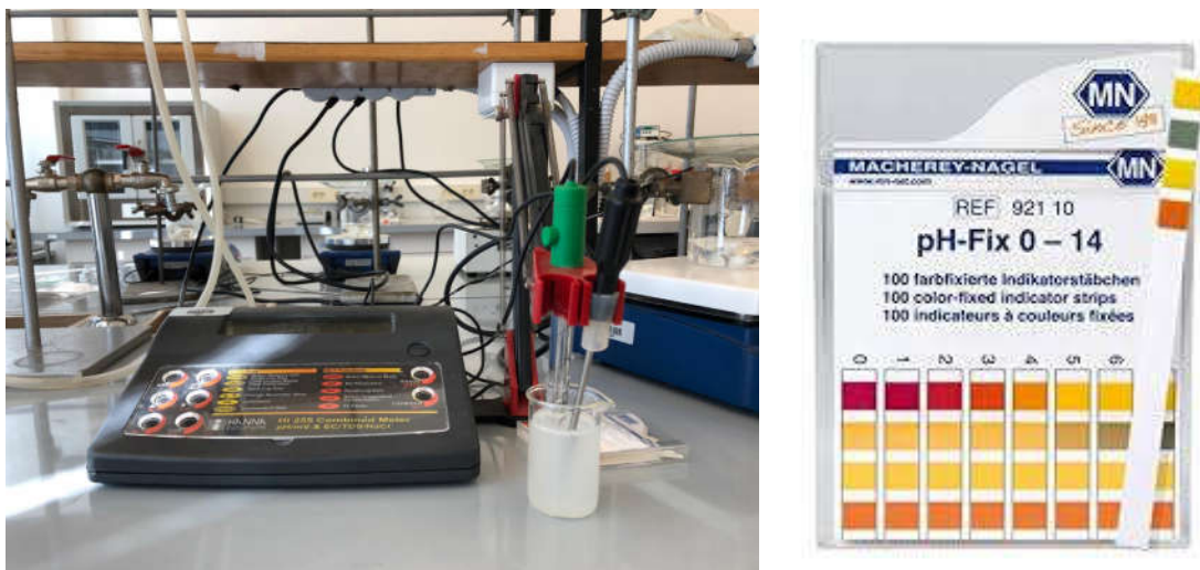
Slika 15. pH metar i pH papir marke „Macherey - Nagel”
