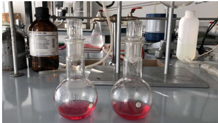
Slika 14. Uzorci nakon titracije s KOH
