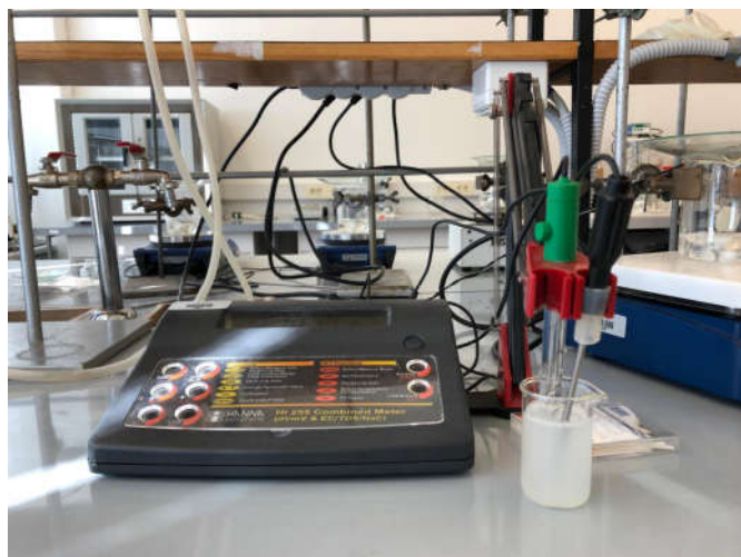
Slika 17. Uređaj za mjerenje vodljivosti otopina
