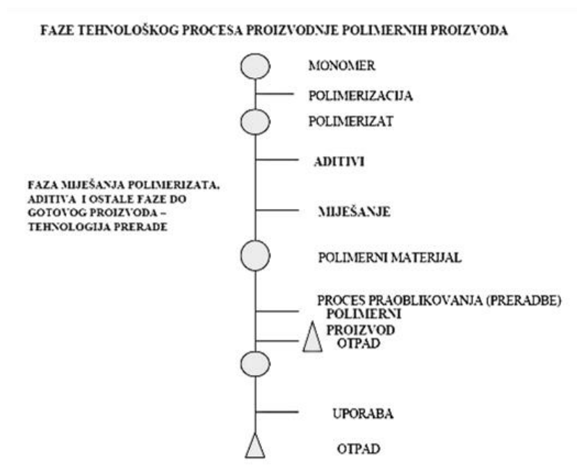
Slika 1. Faze tehnološkog procesa proizvodnje polimernih proizvoda 3
