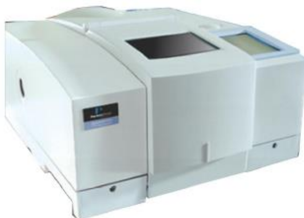
Slika 15. FTIR spektrometar Spectrum One (PerkinElmer, SAD)
