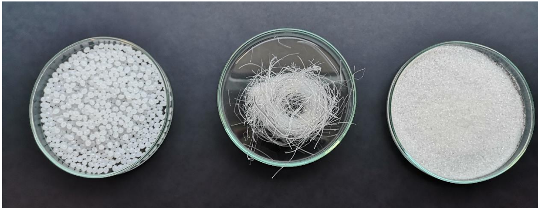
Slika 13. Granule, vlakna, prah PLA-a
