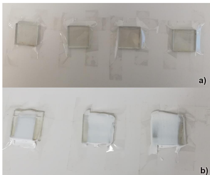
Slika 27. Nanošenje ljepljive trake (a); nanoseni sloj paste (b)
