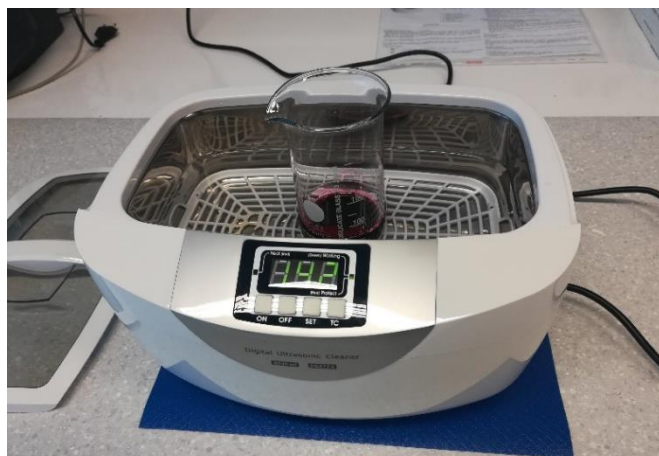
Slika 22. Potpomognuta ekstrakcija antocijanina u ultrazvučnoj kupelji
