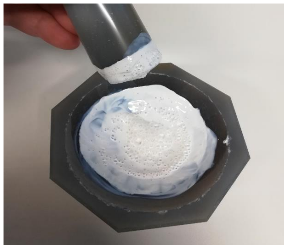
Slika 25. Priprava \text{TiO}_2 paste
