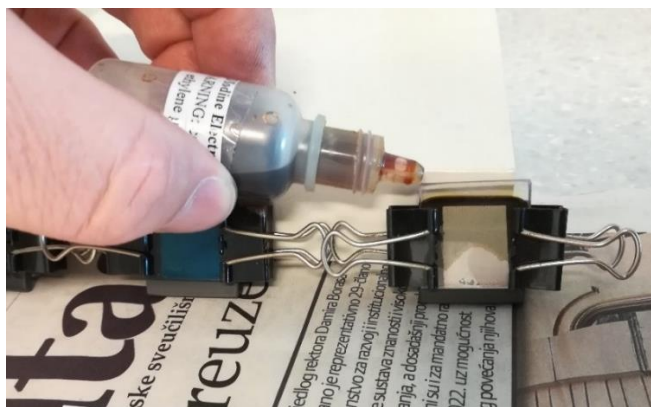
Slika 33. Dodatak otopine elektrolita
