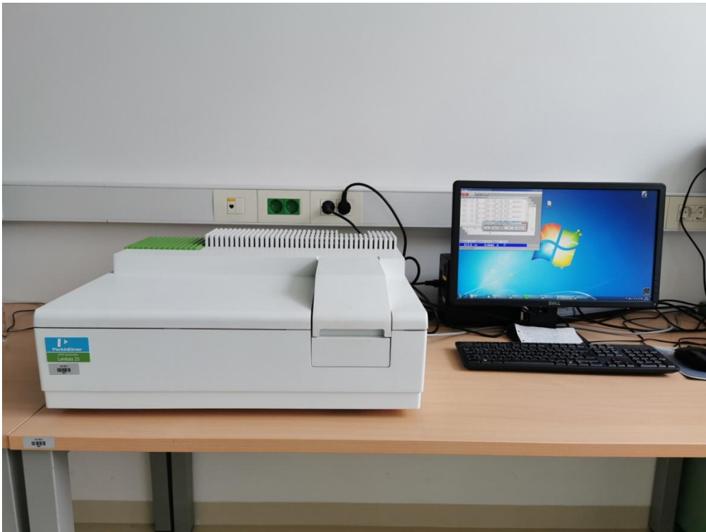
Slika 2.5. Spektrofotometar Perkin Elmer Lambda 25
