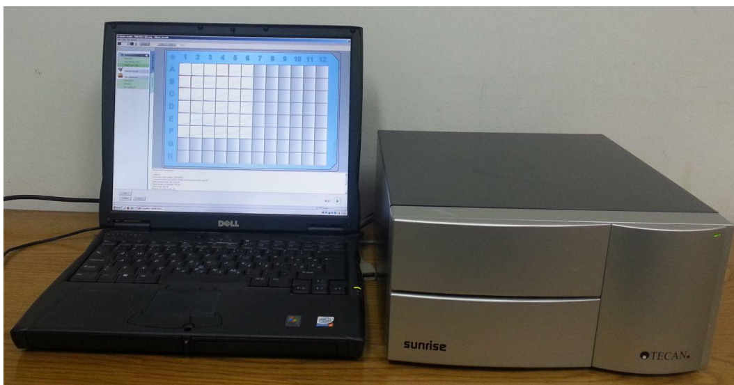
Slika 17. Višekanalni čitač mikrotitarskih pločica "Sunrise" (Tecan, GmbH, Austrija)
