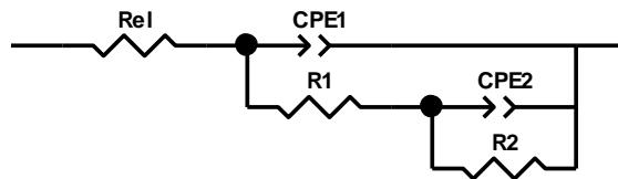
**Slika 4.1.** Shema električnog ekvivalentnog kruga korištenog za matematičko usklajivanje rezultata
