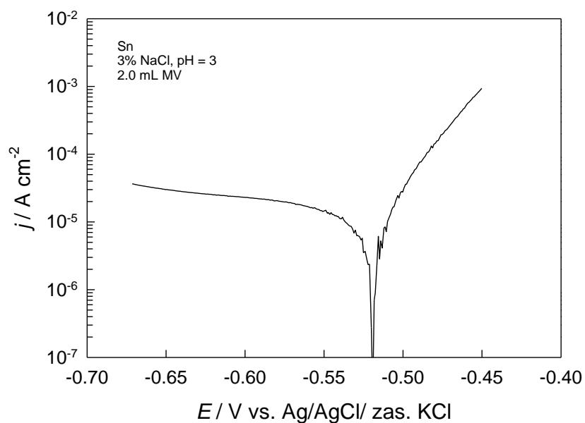
**Slika 3.12.** Tafelov prikaz polarizacijske krivulje elektrode od kositra u 3%-tnoj otopini NaCl, pH = 3.0 uz dodatak 2.0 mL MV, snimljene brzinom promjene potencijala od  $10 \text{ mV s}^{-1}$ .
