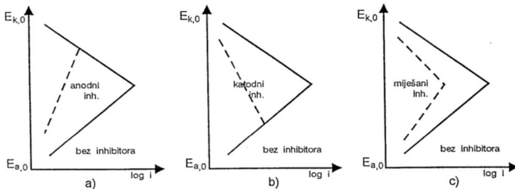
Slika 1.3. Prikaz djelovanja korozijskih inhibitora: a) anodni, b) katodni i c) miješani.<sup>6</sup>
