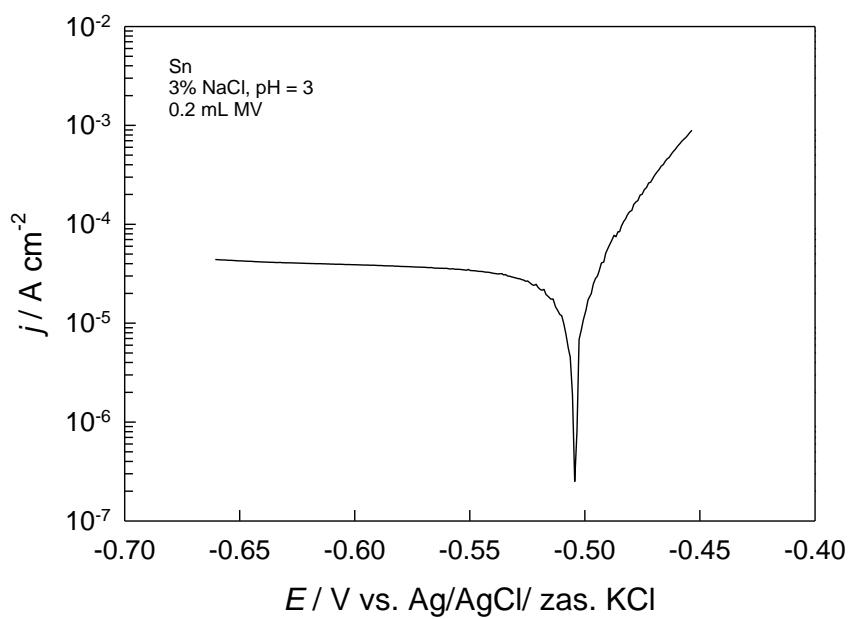
**Slika 3.9.** Tafelov prikaz polarizacijske krivulje elektrode od kositra u 3%-tnoj otopini  $\text{NaCl}$ ,  $\text{pH} = 3.0$  uz dodatak  $0.2 \text{ mL MV}$ , snimljene brzinom promjene potencijala od  $10 \text{ mV s}^{-1}$ .
