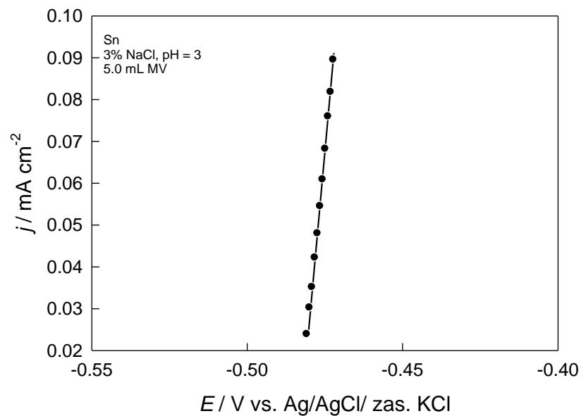
**Slika 3.7.** Polarizacijska krivulja elektrode od kositra u 3%-tnoj otopini  $\text{NaCl}$ ,  $\text{pH} = 3.0$ , uz dodatak 5.0 mL MV snimljena brzinom promjene potencijala od  $1 \text{ mV s}^{-1}$ .
