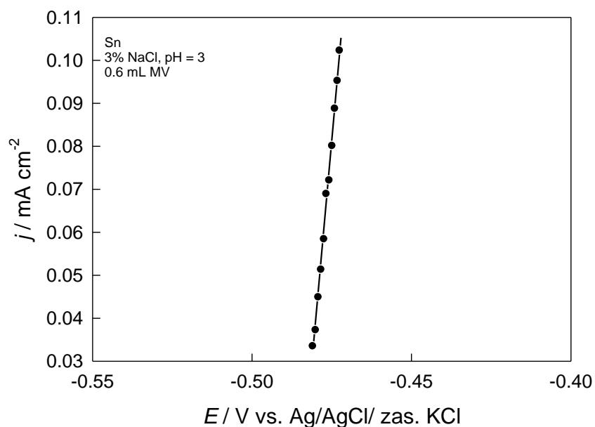
**Slika 3.5.** Polarizacijska krivulja elektrode od kositra u 3%-tnoj otopini  $\text{NaCl}$ ,  $\text{pH} = 3.0$ , uz dodatak  $0.6 \text{ mL MV}$  snimljena brzinom promjene potencijala od  $1 \text{ mV s}^{-1}$ .
