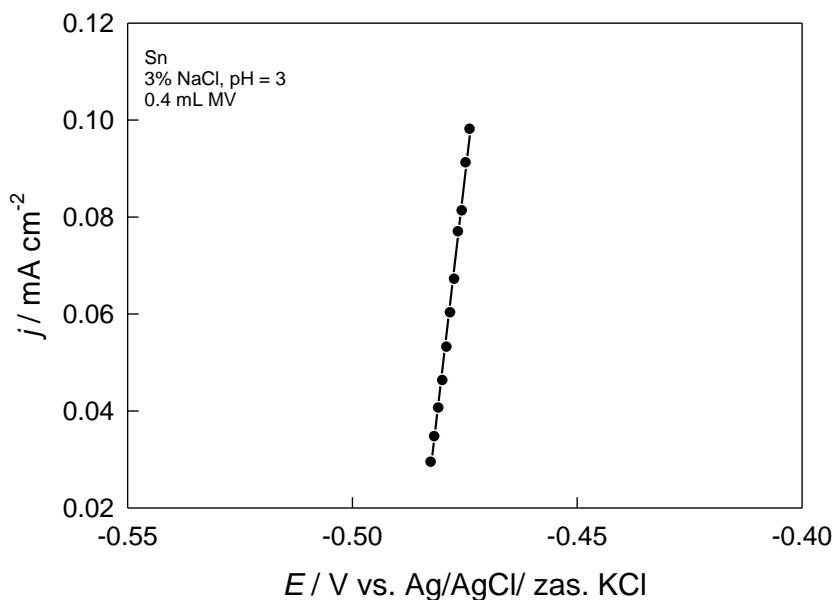
**Slika 3.4.** Polarizacijska krivulja elektrode od kositra u 3%-tnoj otopini  $\text{NaCl}$ ,  $\text{pH} = 3.0$ , uz dodatak  $0.4 \text{ mL MV}$  snimljena brzinom promjene potencijala od  $1 \text{ mV s}^{-1}$ .
