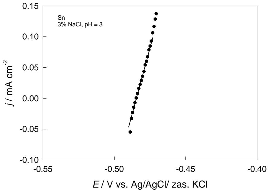
**Slika 3.2.** Polarizacijska krivulja elektrode od kositra u 3%-tnoj otopini  $\text{NaCl}$ ,  $\text{pH} = 3.0$ , snimljena brzinom promjene potencijala od  $1 \text{ mV s}^{-1}$ .
