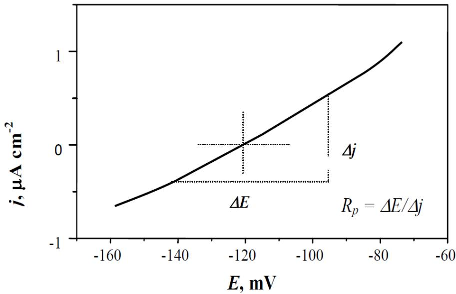
**Slika 1.4.**Određivanje polarizacijskog otpora prema F. Mansfeldu<sup>12</sup>
