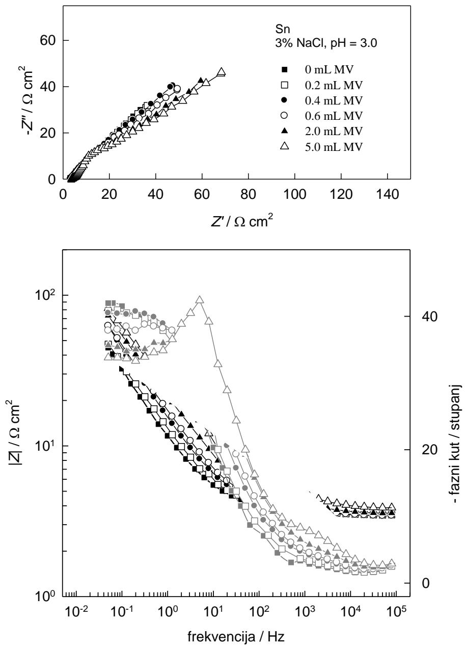
**Slika 3.14.** Nyquistov i Bodeov prikaz utjecaja meda na impedancijske spekture elektrode Sn u 3%-tnoj otopini  $\text{NaCl}$ ,  $\text{pH}=3.0$ , pri potencijalu otvorenog strujnog kruga
