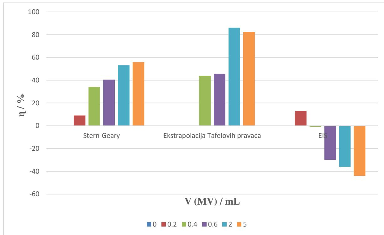
**Slika 4.2.** Usporedba djelotvornosti inhibicije kositra uz i bez dodatka otopine meda u 3 % - tnoj otopini NaCl, pH = 3.0 određene iz polarizacijskog otpora u uskom području potencijala, ekstrapolacijom Tafelovih pravaca i elektrokemijskom impedancijskom spektroskopijom.
