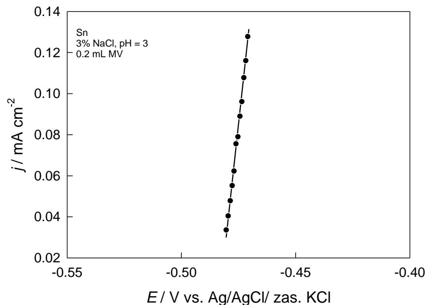
**Slika 3.3.** Polarizacijska krivulja elektrode od kositra u 3%-tnoj otopini  $\text{NaCl}$ ,  $\text{pH} = 3.0$ , uz dodatak 0.2 mL MV snimljena brzinom promjene potencijala od  $1 \text{ mV s}^{-1}$ .
