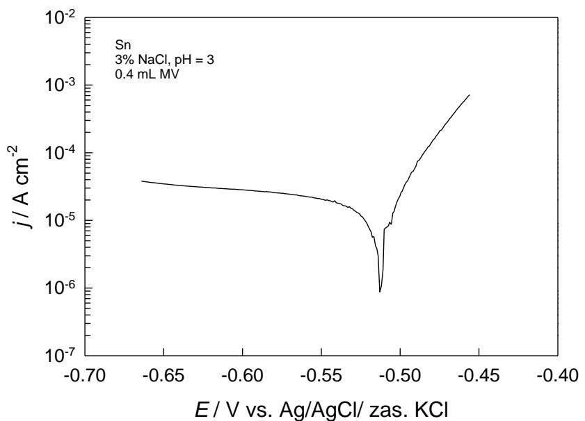
**Slika 3.10.** Tafelov prikaz polarizacijske krivulje elektrode od kositra u 3%-tnoj otopini NaCl, pH = 3.0 uz dodatak 0.4 mL MV, snimljene brzinom promjene potencijala od  $10 \text{ mV s}^{-1}$ .
