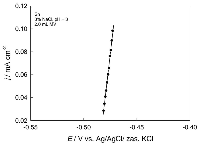
**Slika 3.6.** Polarizacijska krivulja elektrode od kositra u 3%-tnoj otopini  $\text{NaCl}$ ,  $\text{pH} = 3.0$ , uz dodatak 2.0 mL MV snimljena brzinom promjene potencijala od  $1 \text{ mV s}^{-1}$ .
