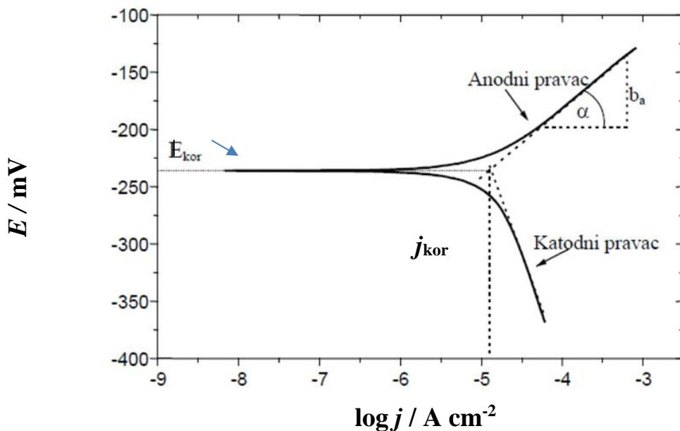
**Slika 1.5.** Tafelova metoda određivanja korozijskih parametara iz polarizacijskih mjerena<sup>14</sup>
