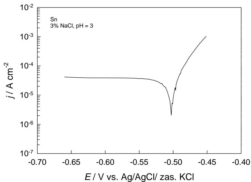
**Slika 3.8.** Tafelov prikaz polarizacijske krivulje elektrode od kositra u 3%-tnoj otopini NaCl,  $\text{pH} = 3.0$ , snimljene brzinom promjene potencijala od  $10 \text{ mV s}^{-1}$ .
