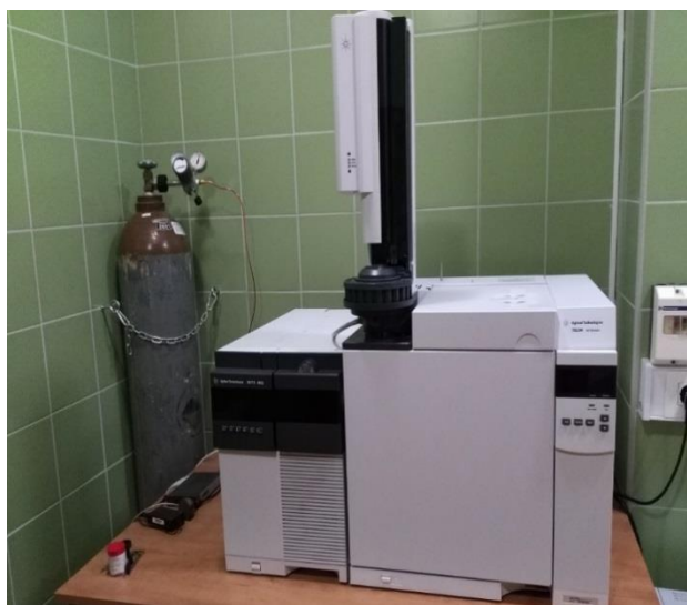
Slika 16. Vezani sustav plinska kromatografija-spektrometrija masa (GC-MS)(Marijanović,2014).
