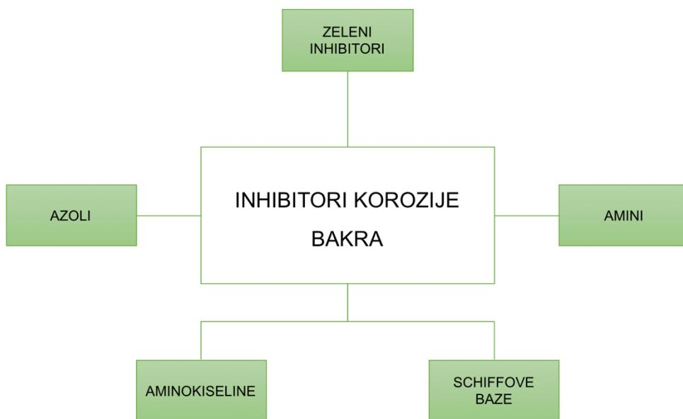
Slika 12. Najčešći inhibitori korozije bakra.
