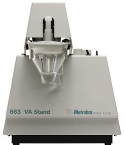
Slika 12. Prikaz kapajuće živine elektrode sa držačem firme Metrohm<sup>(60)</sup>
