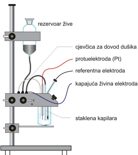
Slika 7. Shematski prikaz sustava za polarografsko mjerjenje
