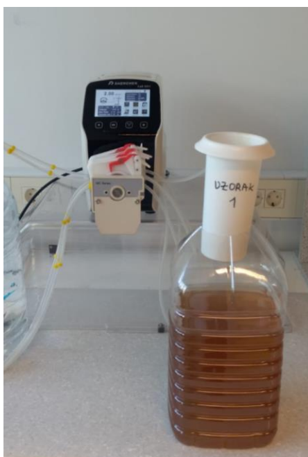
Slika 2.1. Izvedba eksperimenta simulacije dobivanja procjedne vode komine masline
