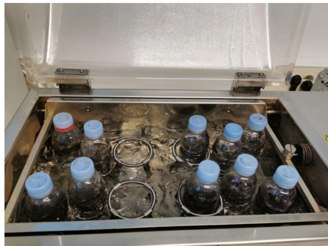
Slika 2.7. Reaktori u vodenoj kupelji s trešnjom
