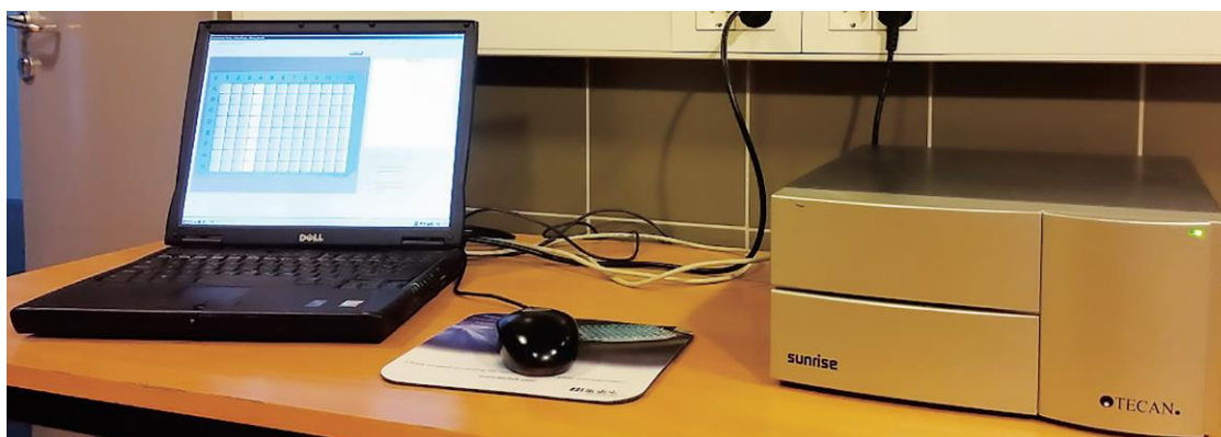
Slika 3.10. Višekanalni spektrofotometrijski čitač mikrotitarskih pločica „Sunrise“
