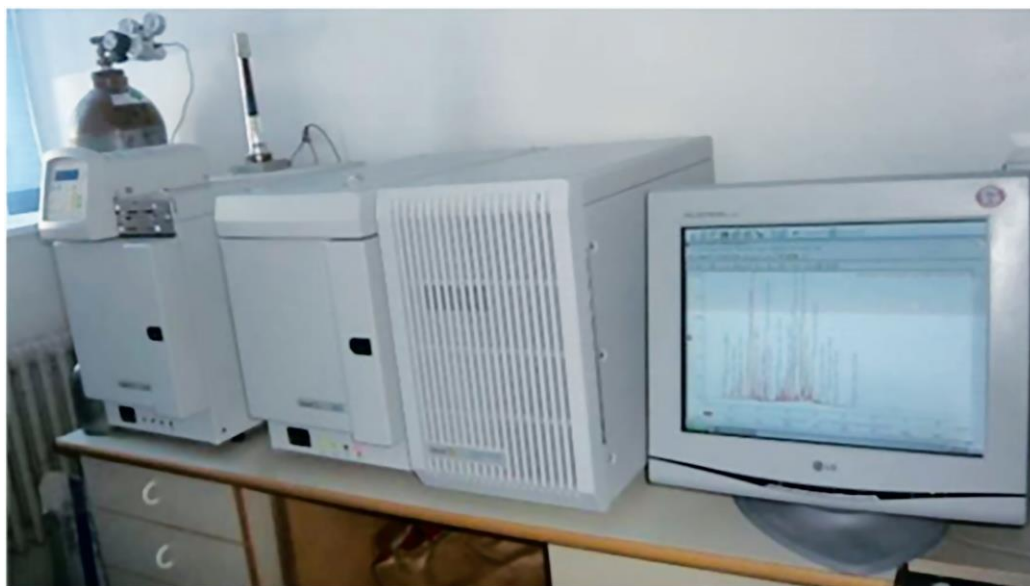
Slika 3.5. Vezni sustav plinski kromatograf - maseni spektrometar (GC/MS)
