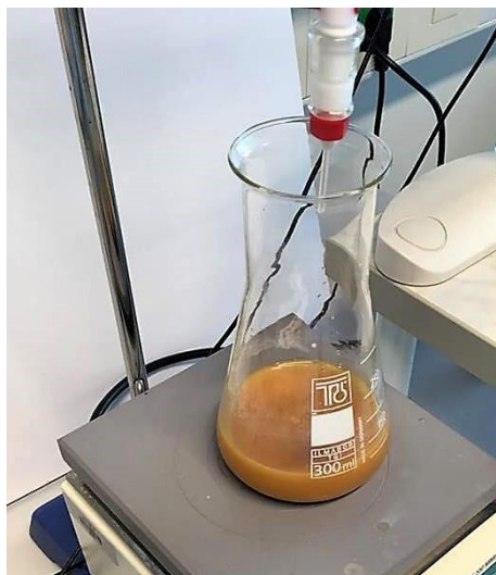
Slika 2.3. Određivanje bakrovih(II) iona - prije završne točke titracije
