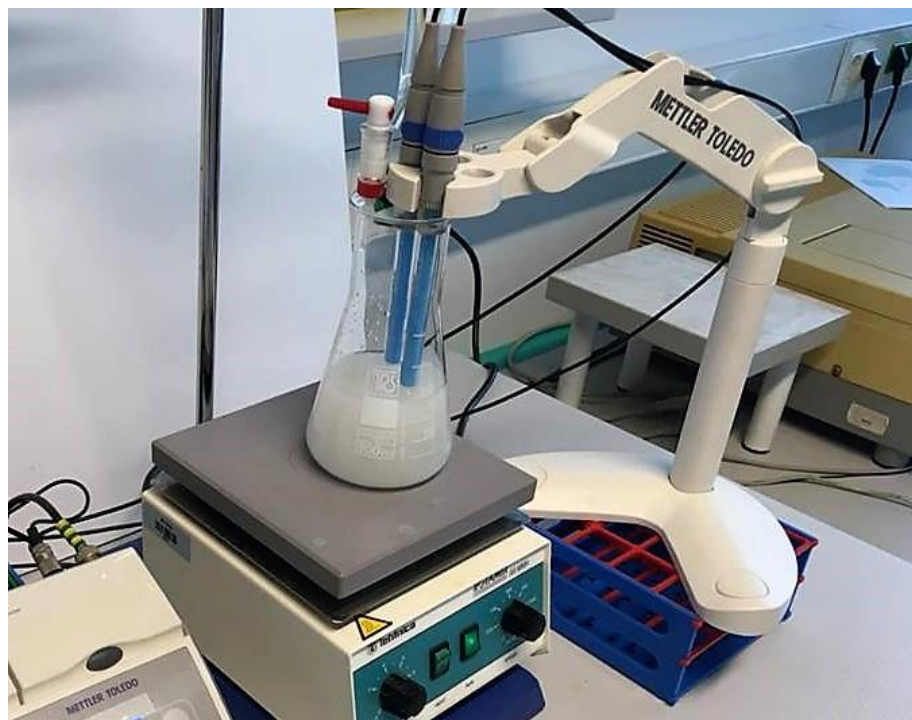
Slika 3.6. Prikaz aparature za potenciometrijsko praćenje redoks-titracije, određivanja bakrovih(II) iona u završnoj točki titracije
