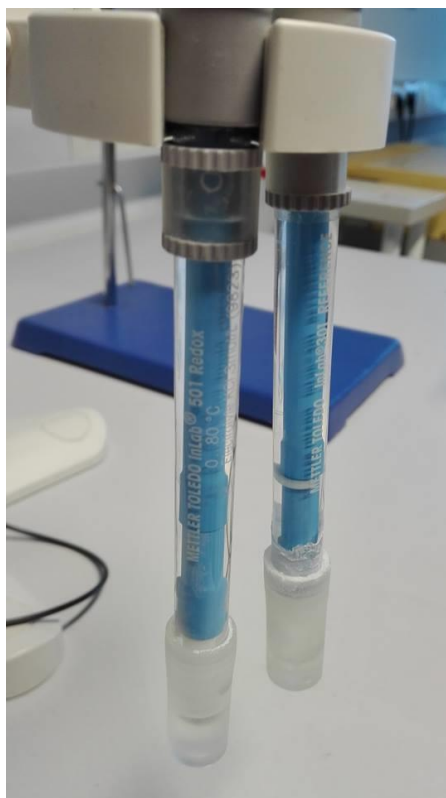
Slika 2.4. Redoks elektroda i referentna Ag/AgCl elektroda
