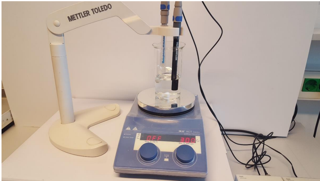
Slika 2-1 Milivoltmetar Mettler Tolero SevenMulti opremljen ion selektivnom elektrodom Ag/AgCl.
