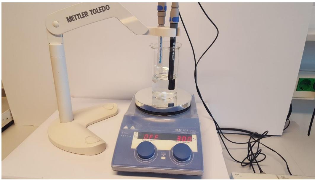
Slika 2-1 Milivoltmetar Mettler Tolero SevenMulti opremljen ion selektivnom elektrodom
