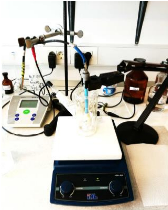
Slika 3.1. Uređaj za potenciometrijska određivanja [17]
