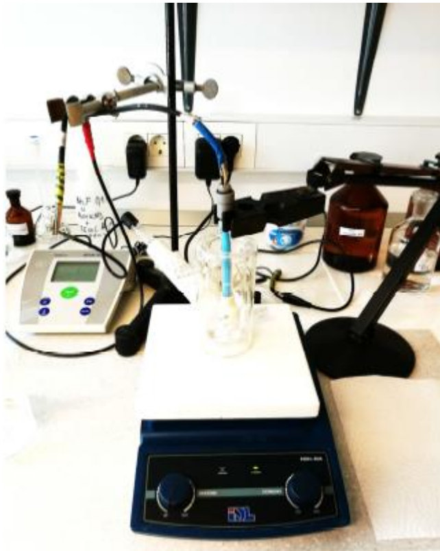
Slika 3.1. Uređaj za potenciometrijska određivanja [17]
