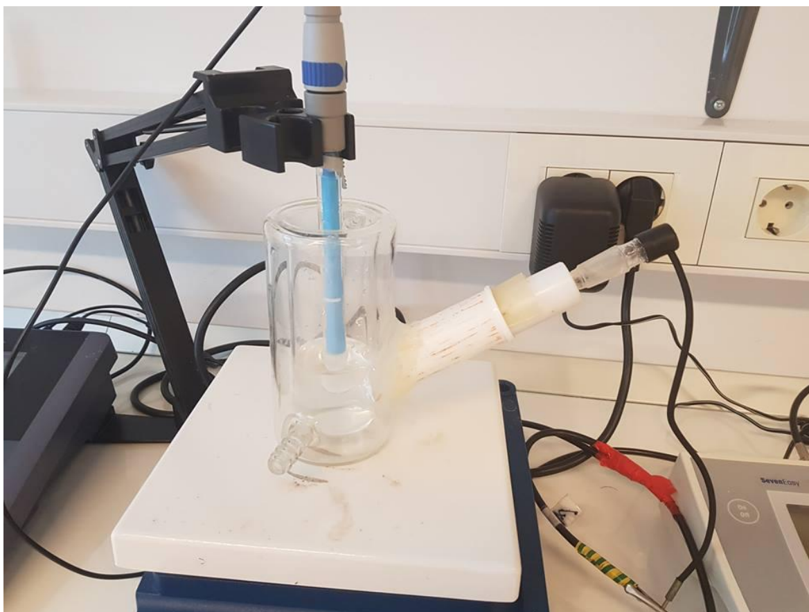
Slika 11 - Aparatura za potenciometriju
