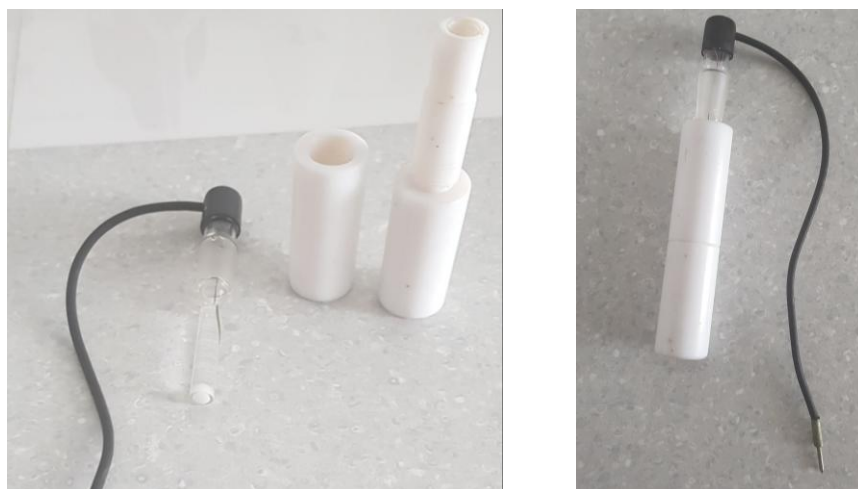
Slika 10 – tijelo za elektrodu
