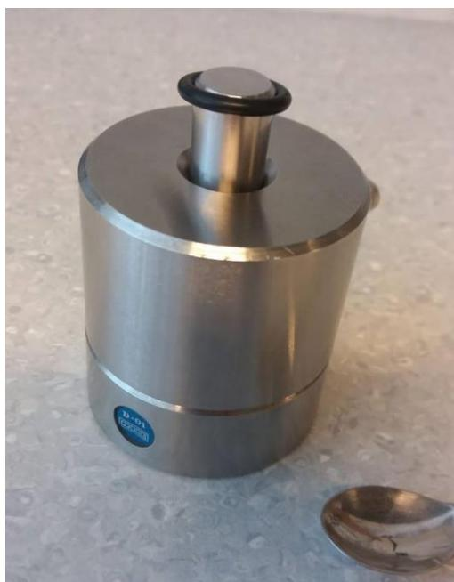
**Slika 2.2.2.1.** Kalup za pripremu membrane
