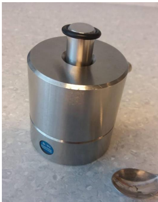
Slika 2.2.2.1. Kalup za pripremu membrane
