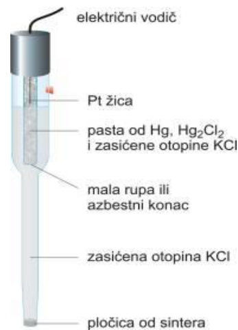
Slika 5. Prikaz kalomelove elektrode 3
