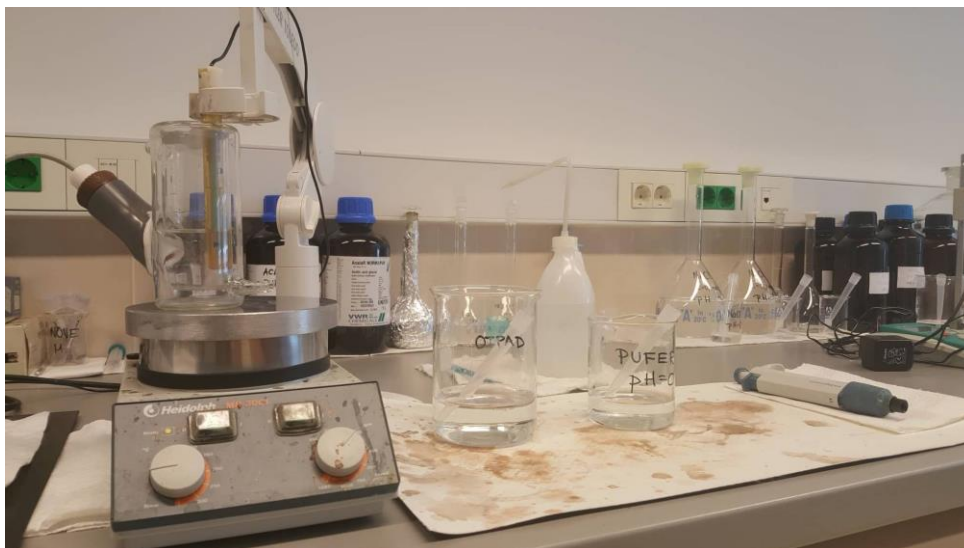
Slika 7. Aparatura za potenciometrijsko mjerenje
