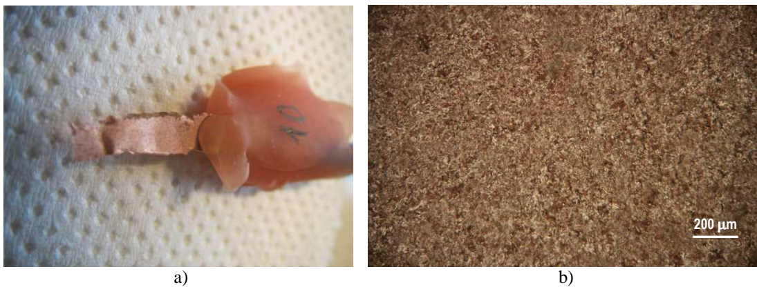
Slika 24. a) makro snimka i b) mikroskopska snimka površine CuAlMnTi legure nakon potenciodinamičkog polarizacijskog mjerenja u 0,9 % NaCl otopini ( pH = 7,4 ) pri T = 24\text{ }^{\circ}\text{C}
