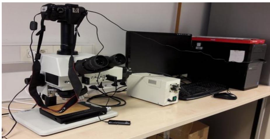
Slika 17. Optički mikroskop MXFMS-BD, Ningbo Sunny Instruments Co.
