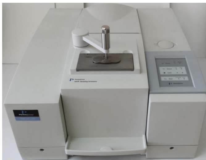
Slika 24. FT-IR spektrometar s dodatkom za snimanje HATR tehnikom
