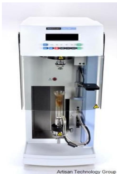
Slika 23. Aparatura za termogravimetrijsku analizu Perkin-Elmer Pyris 1 TGA 43
