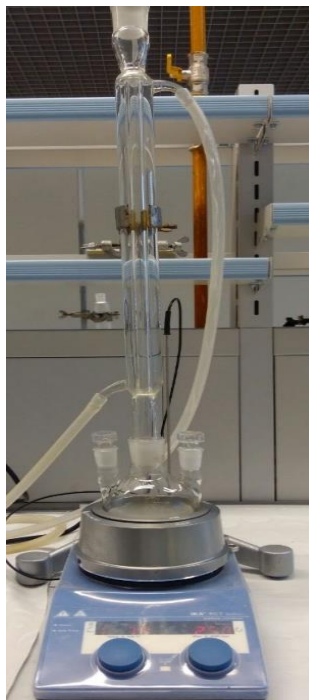
Slika 19. Aparatura za zagrijavanje uz reflux
