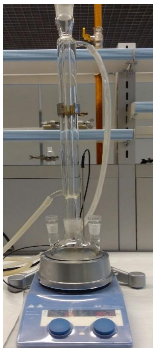
Slika 19. Aparatura za zagrijavanje uz reflux
