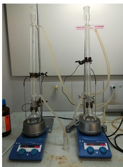
Slika 15. Aparatura za refluksiranje uzoraka PEO/fenil hib-POSS
