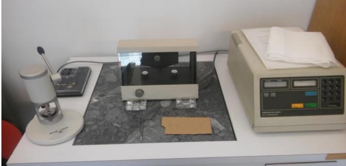
Slika 18. Ultramikrovaga i preša za zatvaranje aluminijskih posudica 37
