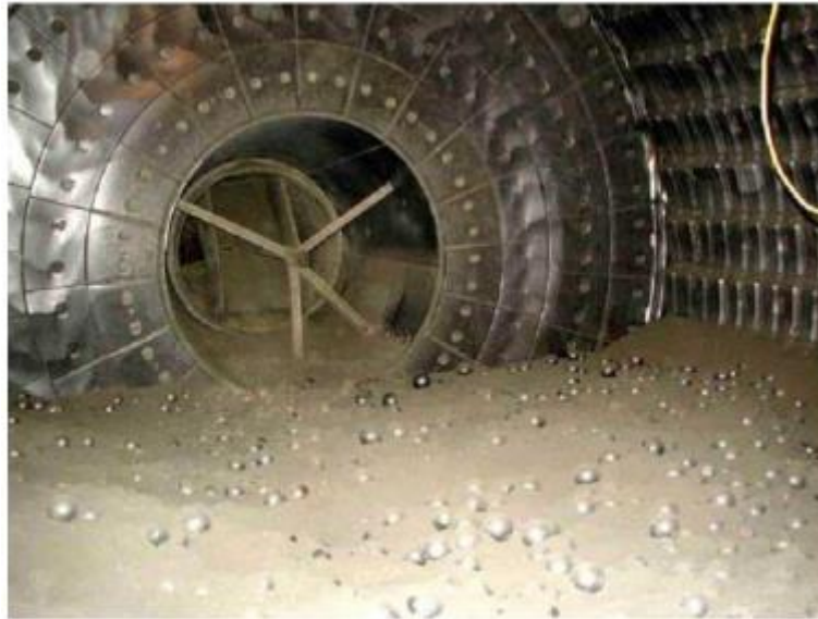
Slika 18. Unutrašnjost mlina s kuglama za mljevenje klinkera [5]
