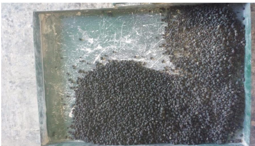
Slika 21. Dobiveni klinker uslijed pečenja na poluindustrijskoj peći
