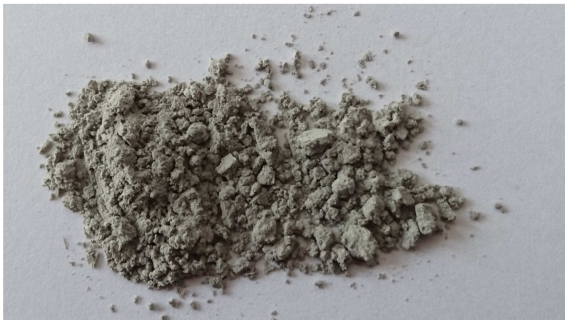
Slika 2.1. Usitnjene čestice modificiranog geopolimera.
