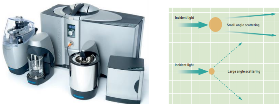
Slika 14. Materizer 3000 i prikaz rasipanja svjetlosti čestica različitih veličina. [15]
