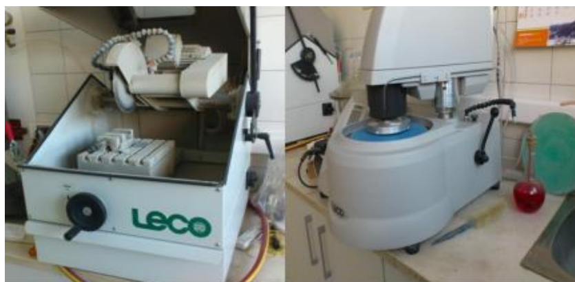
Slika 16. Priprema uzoraka za mikroskopiju a) rezalica materijala, b) brusilica/polirka uzorka.
