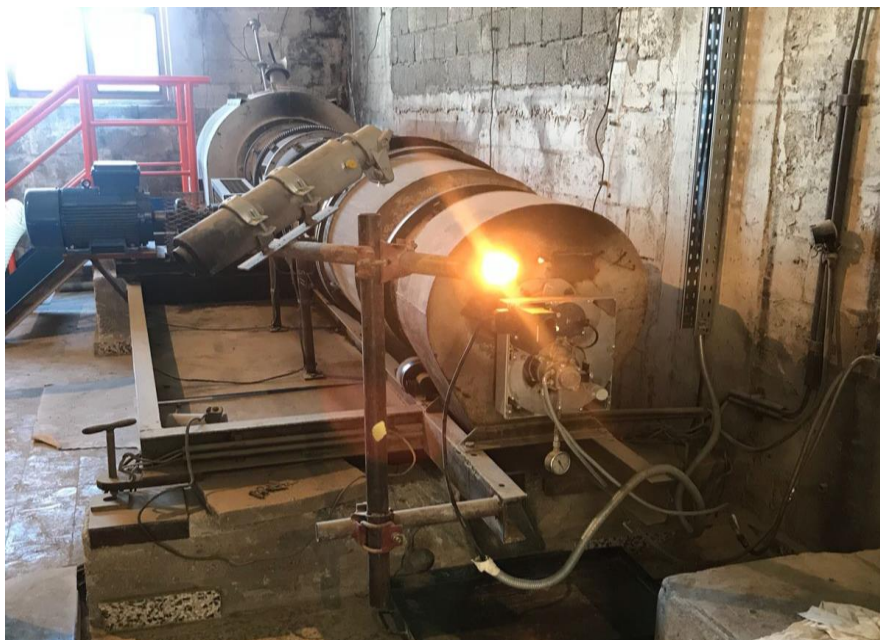
Slika 13. Rotacijska peć za sintezu cementnog klinkera
