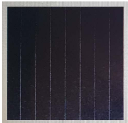
Slika 5. Solarna ćelija na bazi bakar-indij-diselenida (CIS) 4
