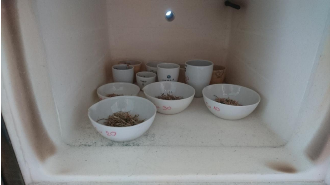
Slika 2.9. Uzorci pripremljeni za žarenje u peći na 500°C
