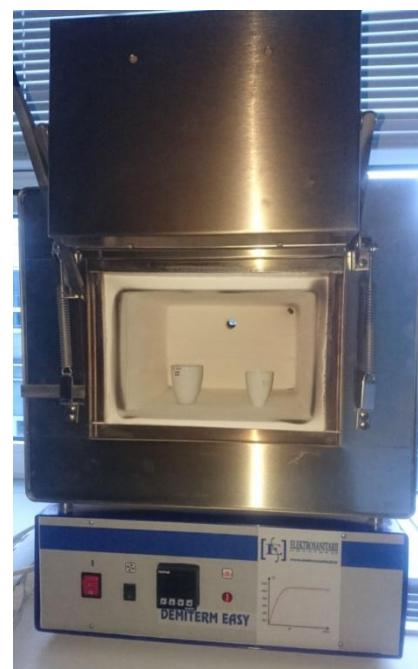
**Slika 2.6. Uzorci pripremljeni za žarenje u peći na 500 °C**
