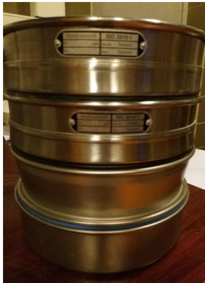
Slika 2.5. Sita s različitim otvorom očica
