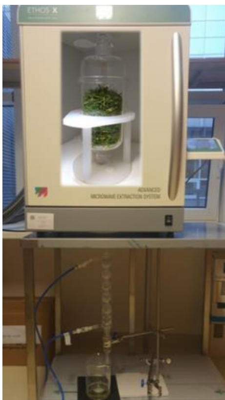
Slika 23. Mikrovalna ekstrakcija uz gravitacijsku silu (donji dio, engl. flavour )
