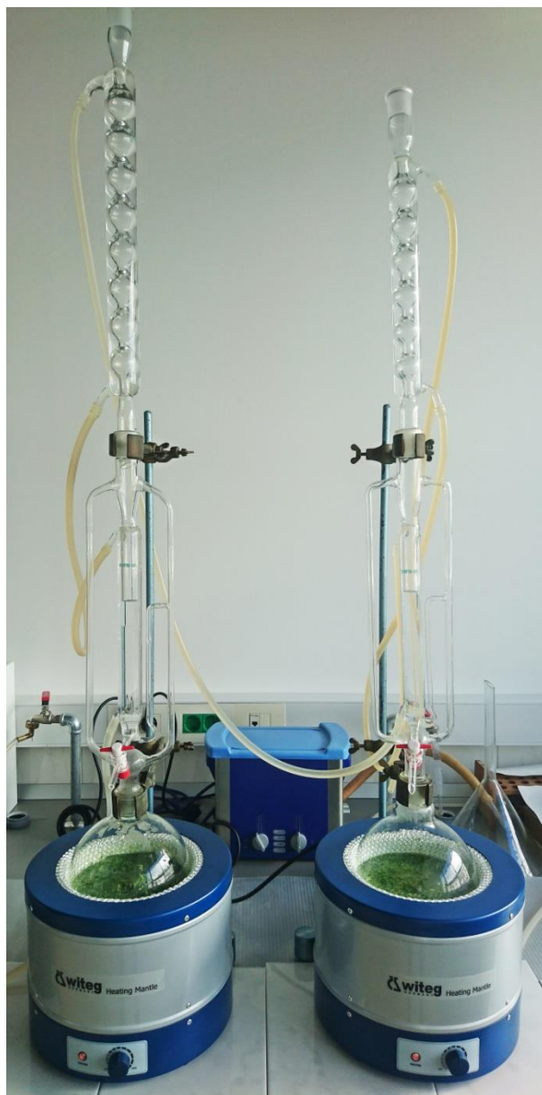
Slika 25. Hidrodestilacija uskolisnog dvoredca.
