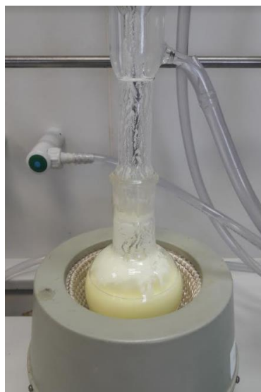
Slika 2.29. Burna reakcija pri previsokoj temperaturi.
