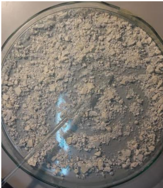
Slika 2.20. Osušeni i usitnjeni talog 2-metil-6-fenil-piridin-3,4-dikarboksilne kiseline.
