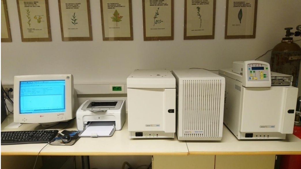
Slika 2.1. GC-MS uređaj (Varian, USA).
