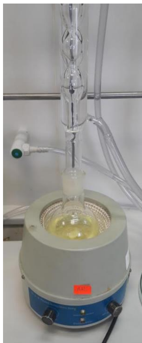
Slika 2.28. Reakcija međuprodukta (4) i hidrazina na refluksu
