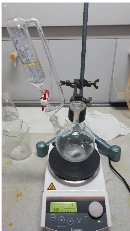
Slika 4.4. Početak sinteze, dokapavanje amilila i kalijevog karbonata.
