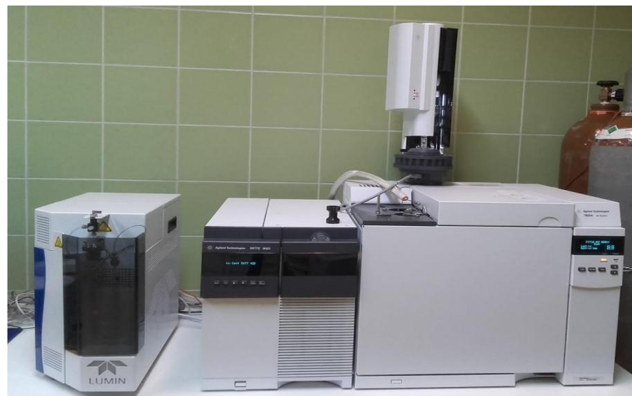
**Slika 9.** Vezani sustav plinska kromatografija-spektrometrija masa (GC-MS)
