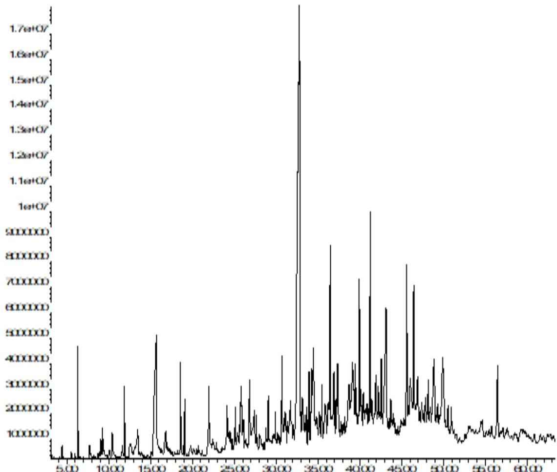
**Slika 10.** Kromatogram ukupne ionske struje prije zagrijavanja meda od facelije izoliran pomoću USE ekstrakcije sa organskim otapalom diklormetanom.
