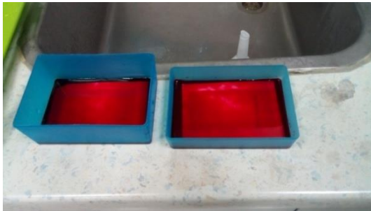
Slika 24: Bojanje membrana s PonceouS bojom
