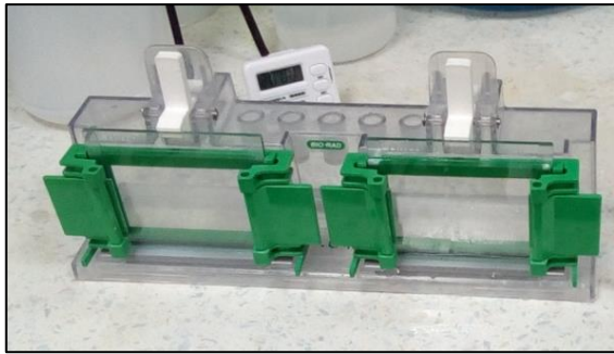
Slika 17: Izrada gelova za elektroforezu
